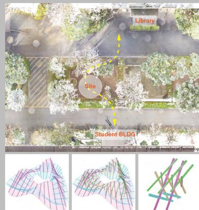
「人の往来を維持する」「人目を適度に制御する」相反する要求に対して、レイヤが複数枚重なった形状で「見え・隠れ」させる。レイヤ複数枚は構造的に寄与することを模型で確認し、レイヤ5枚による形状を採用。同時に、2枚のレイヤ（赤と青）作成・適宜パラメータを設定することで5枚のレイヤ（赤・青・緑・黄・黒）と各レイヤに乗る線材を作成する自動化プログラムを実装し、簡単な操作によって複雑形状を試みる事を可能とする。人間の想像力をマシンによって補助する。
