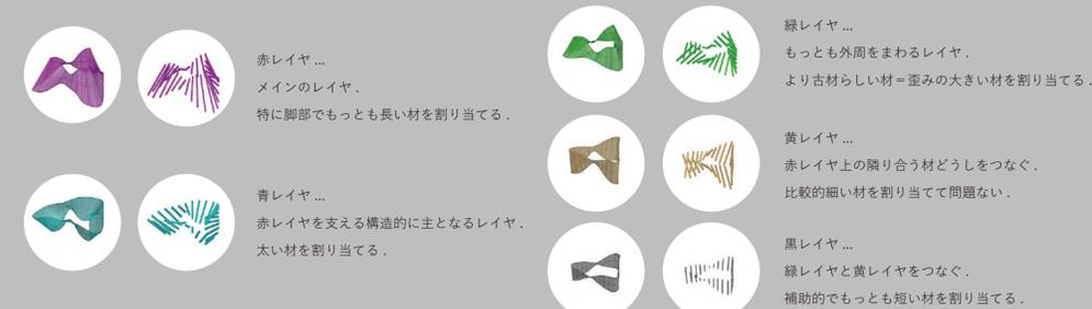
どのレイヤにどのような古材を割り当てるか検討するために割り当てのシステムをつくる。古材の分析マップを利用し、特定の色の線で囲んだ古材を特定のレイヤに割り当てるようにプログラムを組む。割り当ては、各レイヤによる材の取り合いを調停（例えば赤レイヤと緑レイヤが求める材の条件を両方満たす材がある場合どちらに割り当てるか）することを繰り返すことで、形状を決定する。最終的に開口率計算プログラムを回し、必要があれば割り当てを微調整し、なければ形状が最終決定される。
